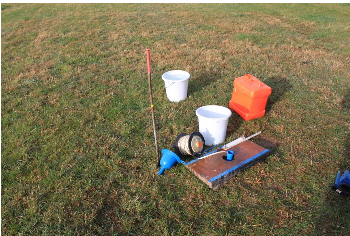
Bild 2: Sickertest im ausgebauten Bohrloch
