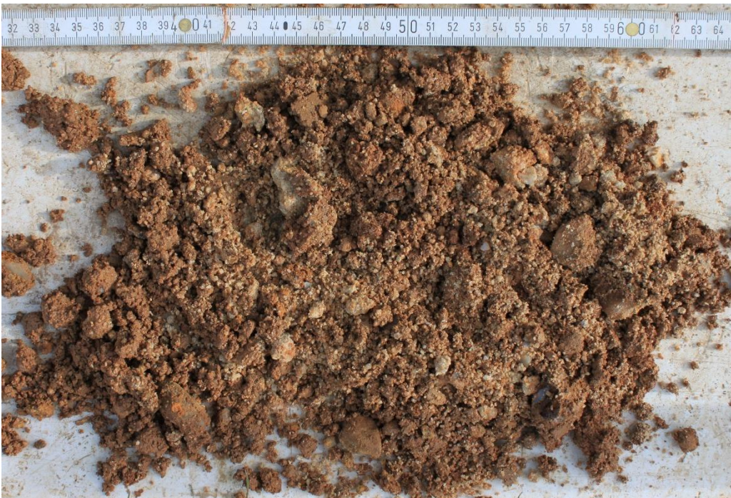
Bild 5: Zersatz (maßgebende versickerungswirksame Schicht – kiesiger Sand, schwach schluffig)
