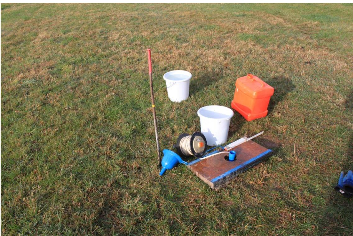
**Bild 2:** Sickertest im ausgebauten Bohrloch
